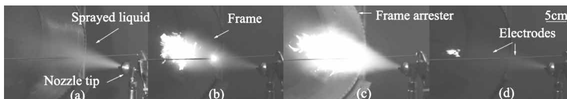
写真2 典型的な噴霧液体の着火パターン(液体の噴霧(a)、着火(b)、火炎伝播(c)、及び消炎(d)) (灯油、放電エネルギー: 7.2 mJ)。
